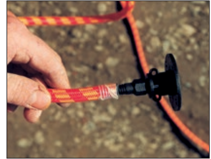
Im Bereich des Filamentbandes abschneiden und den Befestigungspacker eindrehen
