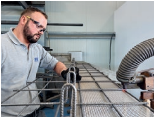
■ Punktschweißung des Streckmetallgitters auf eine Gittermatte
