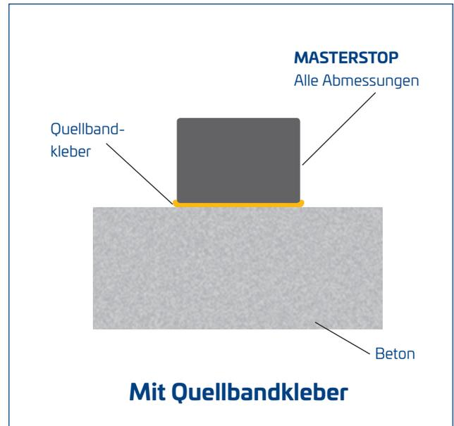
**Auf der Baustelle** Verlegung von **MASTERSTOP**, Abmessung 25/20 mm
