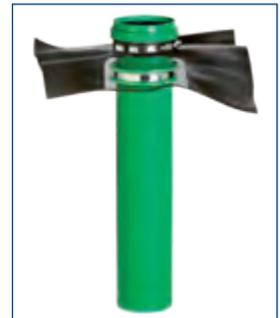
Folienflansch aus PVC-Folie 1,5 mm, Größe: 50x50 cm, schweißbar mit dem Heißluftgerät, klebbar mit Quellschweißmittel. Öl- und Bitumenbeständig
