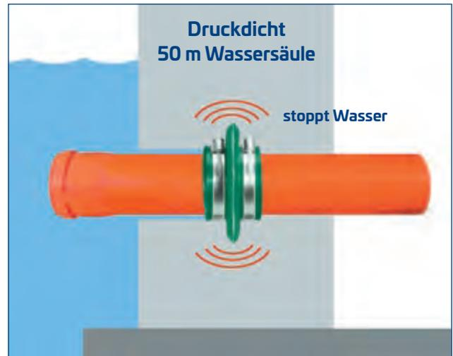
Der Mauerkragen wird einbaufertig mit Spannbandern geliefert.
